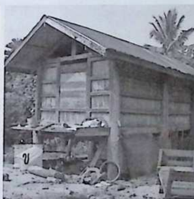
ก. เล้าข้าวที่มีฝาเป็นไม้ไผ่ยาหรือฉาบด้วยดินเหนียวและขี้ควาย
